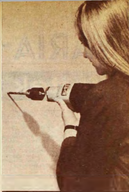
Fúrás az ÚF 1030-as ütvefúró géppel, keményfém betétes csigafúróval
